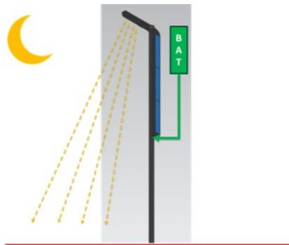
La nuit, l'énergie stockée dans la batterie est utilisée pour alimenter le luminaire à LED.
